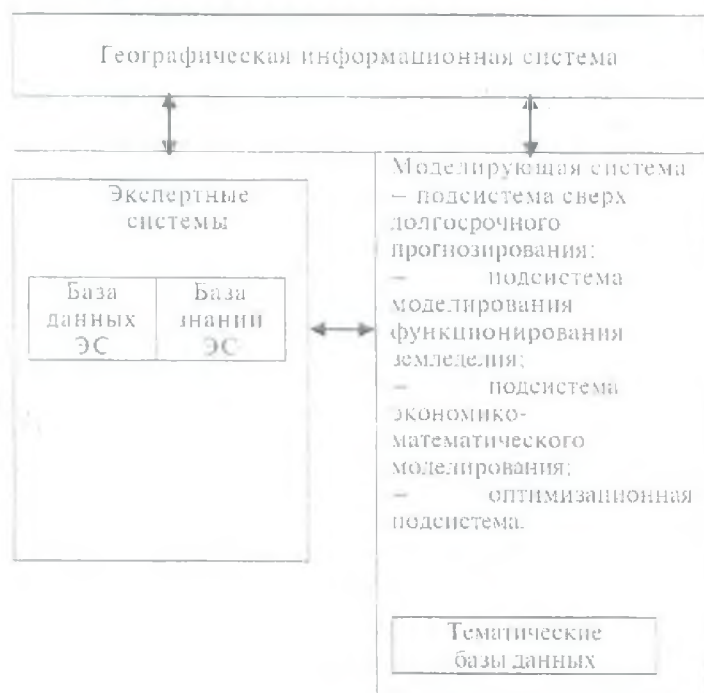
Рис. 2. Обобщенная структура информационной системы с использованием ГИС-технологий.
