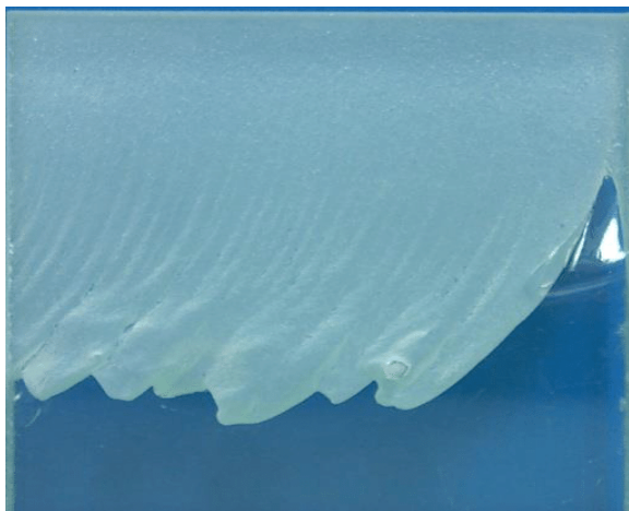
Рисунок 1 – Пропил, испытание в стекло материале
