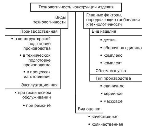
Рисунок 1 – Виды технологичности, факторы и способы оценки технологичности конструкции изделия
