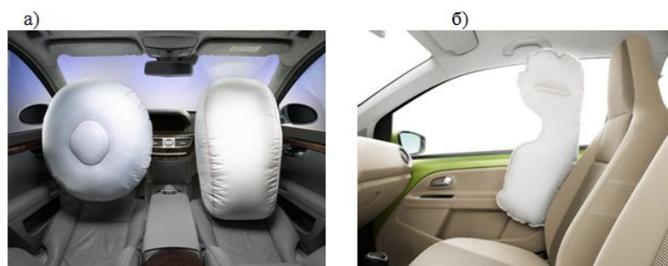
Сурет 2 – Қауіпсіздік жастықшалары: а) фронтальді қауіпсіздік жастықшасы; б) екі жақты қорғаныс жастықшасы
