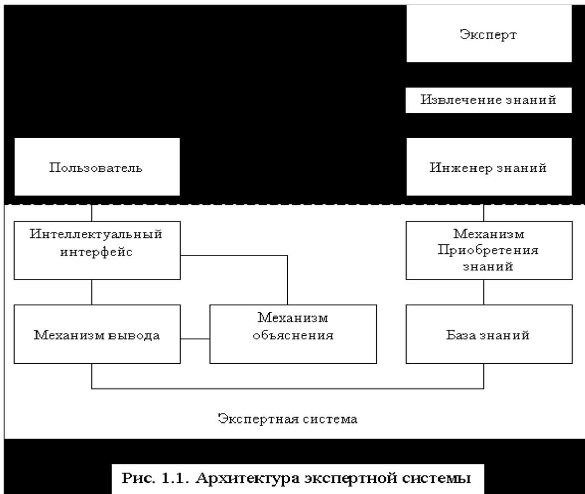
Рис. 1.1. Архитектура экспертной системы
