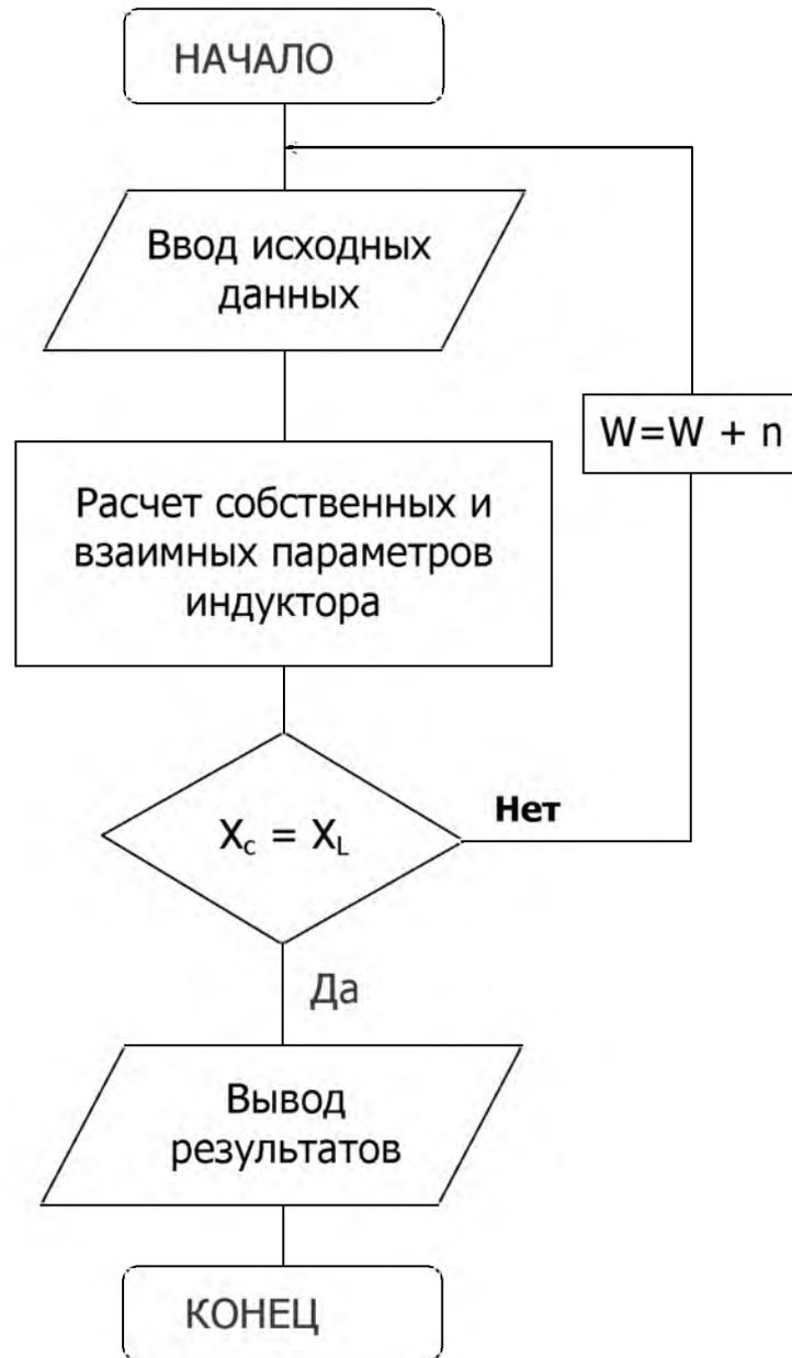
Рисунок 4.5 – Блок-схема программы REZONANS1
