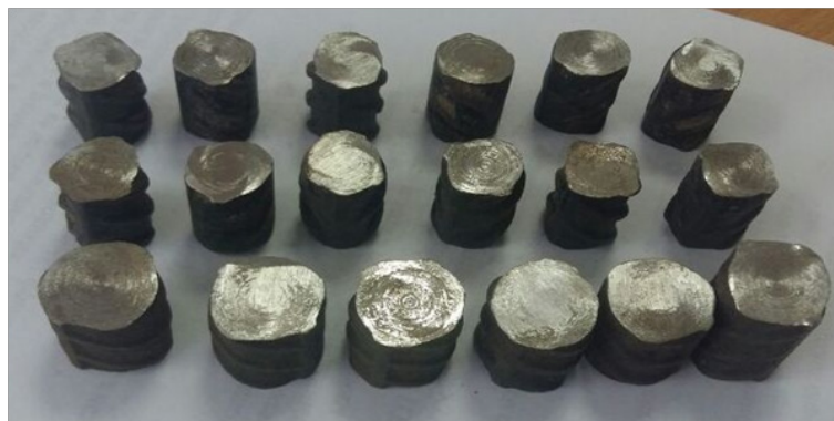
Рисунок 1 – Образцы арматурного проката из сталей Ст.5 и 35ГС (профили № 12 и № 20) перед проведением коррозионных испытаний
