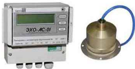
Рисунок 4 – Уровнемер акустический ЭХО – АС – 01
