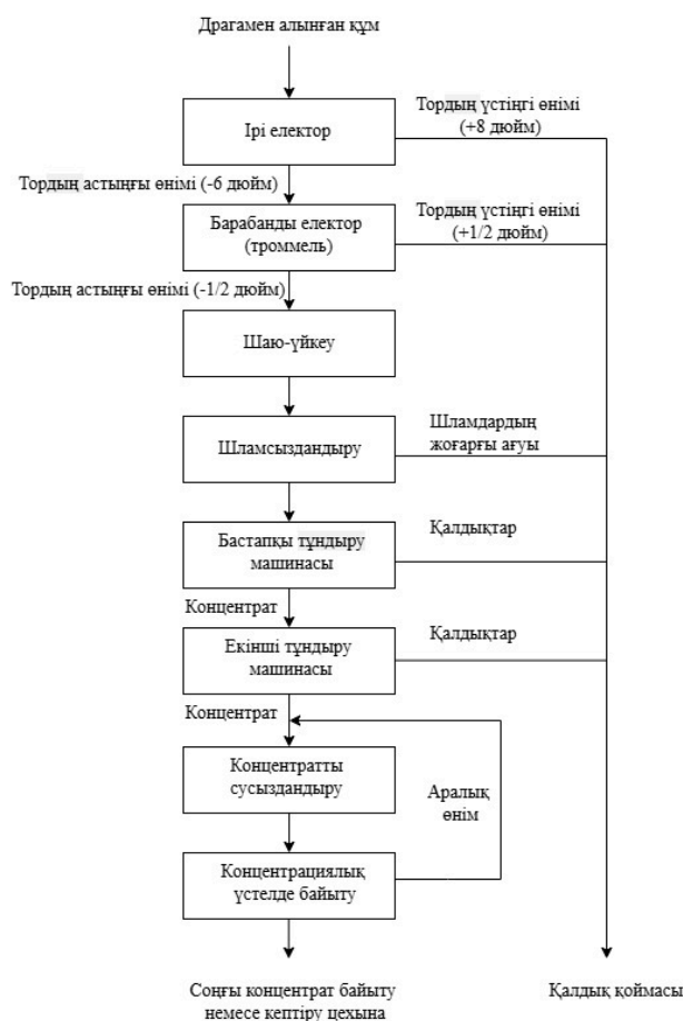
Сурет 1.7 – Ауырлық күшімен байытудың жалпыланған технологиялық схемасы
