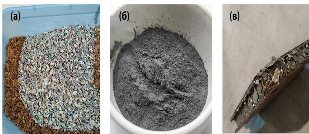
Сурет 4.2 –Материал ұсақтаудан кейінгі күйі: (а) QL-300 барабанды ұсатқыштан кейін; (б) диірменнен кейін; (в) магниттік сепарациядан кейін
