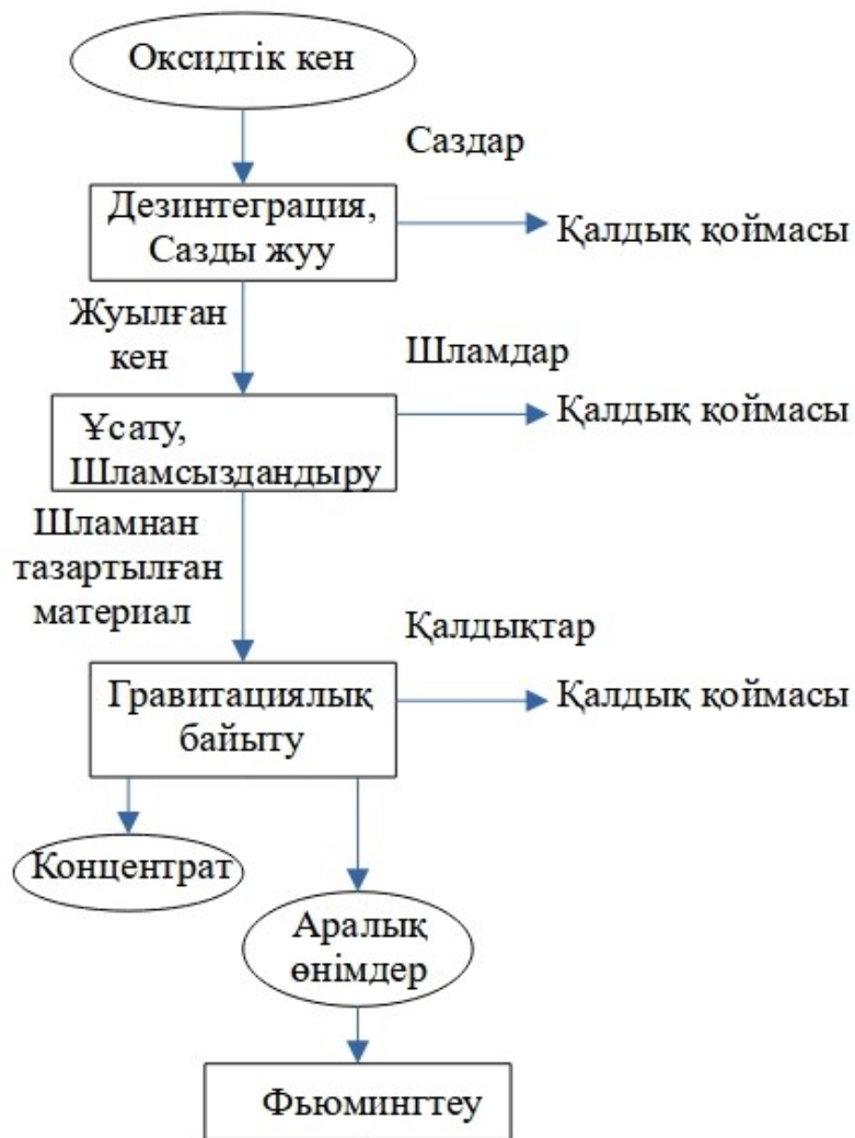
Сурет 1.18 – Сырымбет кен орнының оксидті минералды шикізатын байыту схемасы
