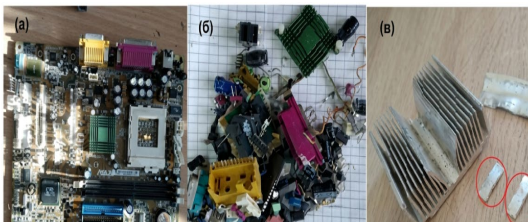
Сурет 4.1 – Электрондық қалдықтар: (а) аналық плата; (б) бөлшектелген элементтер; (с) процессордың салқындатқыш радиаторы.
