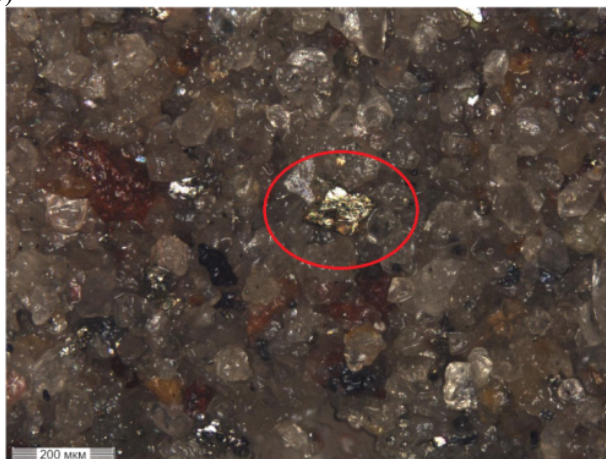
Рисунок 2 – Морфология образца пробы хвостов Майкаинской золотоизвлекательной фабрики № 1
