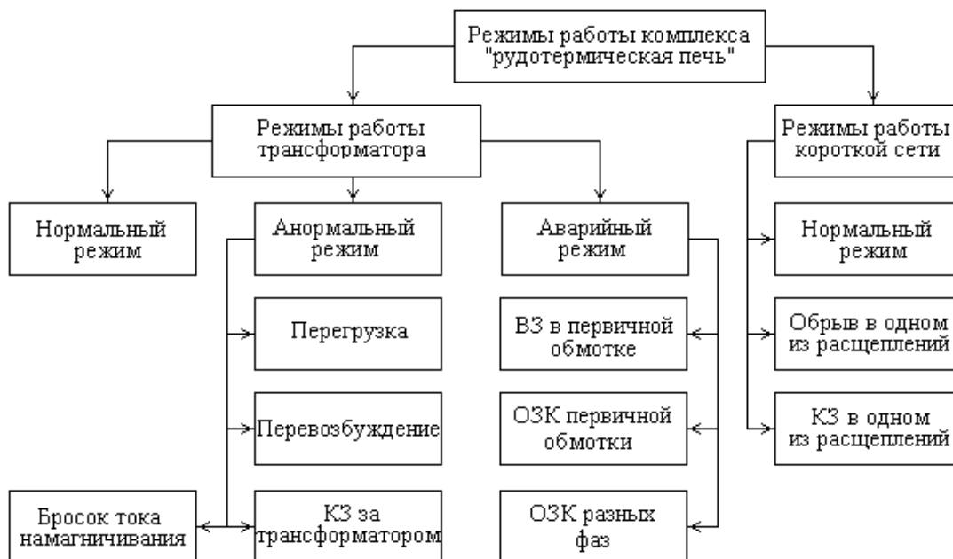
Рисунок 1.15 – Режимы работы комплекса «рудотермическая печь»
