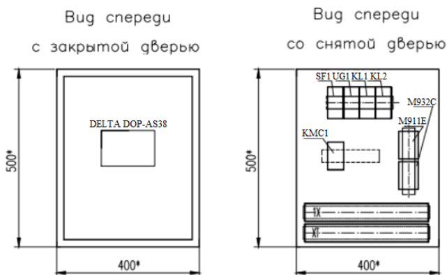
Рисунок 3 – Общий вид шкафа защиты
