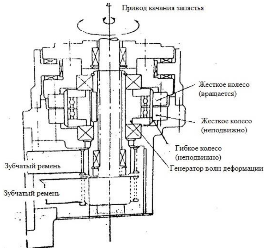
Рис.5. Механизм привода запястья
