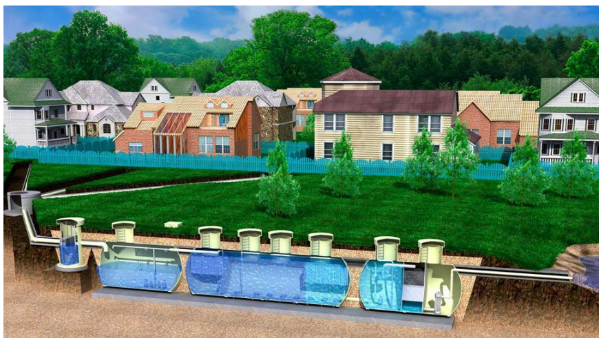
Рис. 1. Технологическая линия очистки сточных вод из полимерного или теплопластикового материалов
