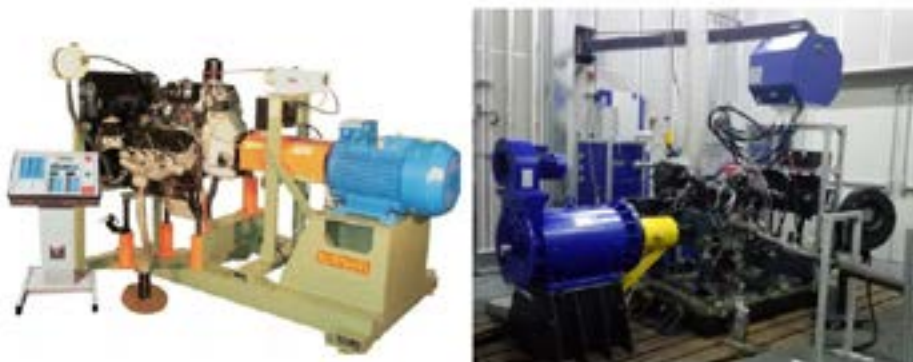
Рисунок 2 – Стенды для обкатки, испытания и исследования двигателей внутреннего сгорания
