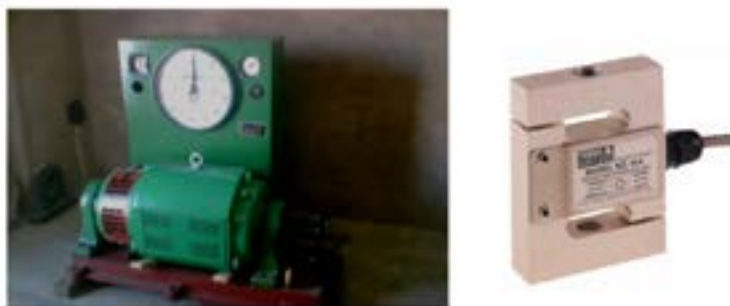
Рисунок 3 – Электрическая машина балансирующего типа с весовой головкой и тензометрическим датчиком для определения крутящего момента
