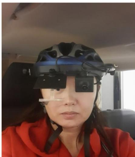
Рисунок 2 – Надеваемый головной Eye-tracker
