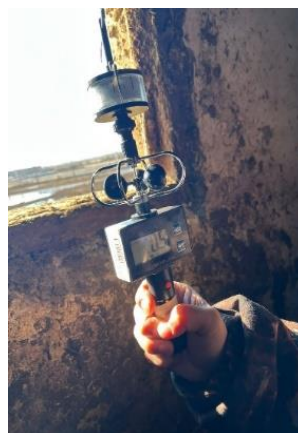
Сурет 4 – Ауа қозғалысы күші мен жылдамдығын өлшеу аспабы
