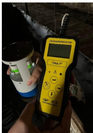
Сурет 3 – ОКА-Т портативті улы газ анализаторы
