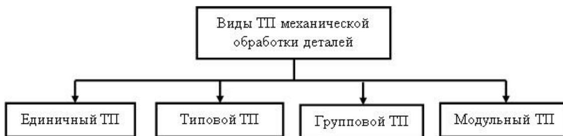
Рисунок 1.1 – Виды технологических подходов механической обработки деталей
