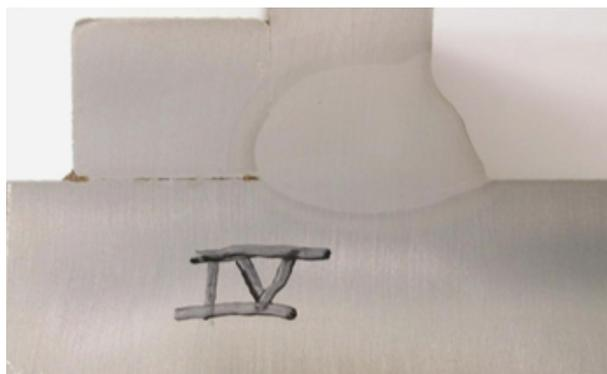
Рисунок 4 – Испытательный образец номер IV с толщиной стенки 10 мм
