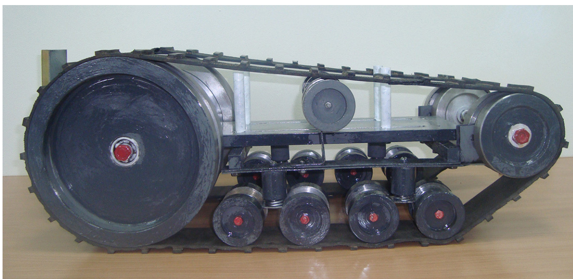
3-сурет – Тарту-көлік машинасы жүріс бөлігінің моделі
