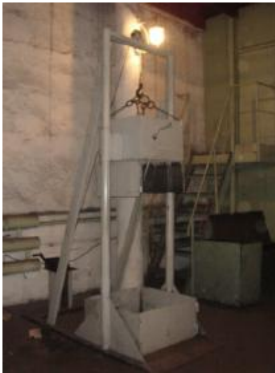
2.10-сурет – Түсірілетін кендердің беріктігін сынауға арналған құрылғы
