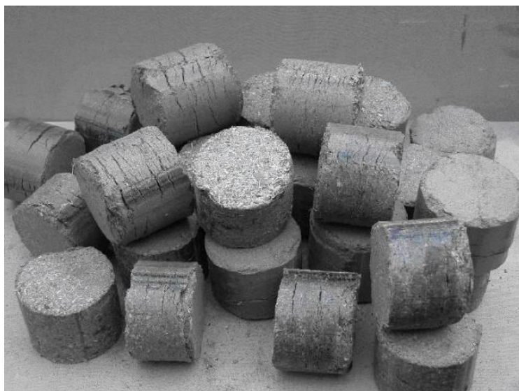
2.14-сурет-металлургиялық қалдықтардан жасалған брикеттер
