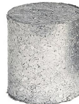
Рисунок 2 – Брикет из алюминиевой стружки
