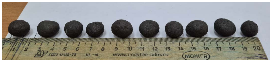
Рисунок 1 – Образцы опытных окатышей из мелкодисперсной пыли
