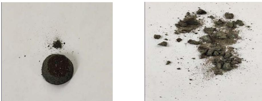
Рисунок 3 – Сплав (оплавленная шихта)
