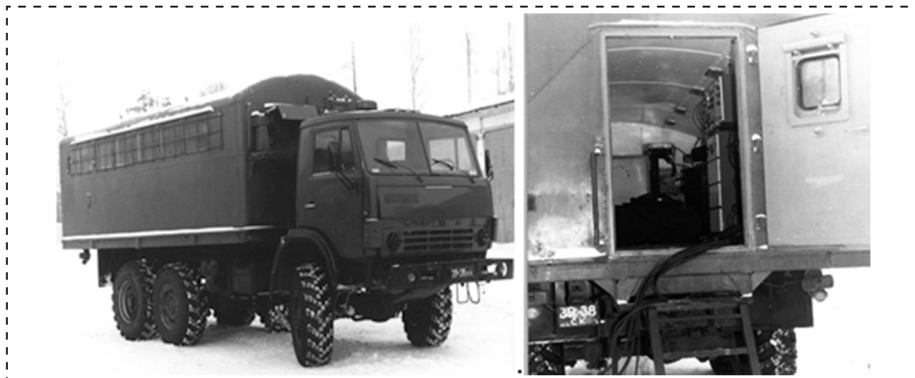
Рис. 1. Мобильный вариант плазменной установки на базе автомобиля «КамАЗ»
