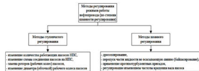
Рисунок 2 – Методы регулирования режимов работы НП по степени плавности регулирования
