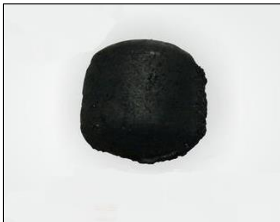
Рисунок 2 – Брикет из коксовой пыли
