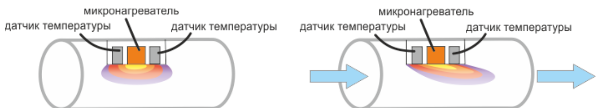
Рисунок 5.6 – Принцип действия калориметрического расходомера
