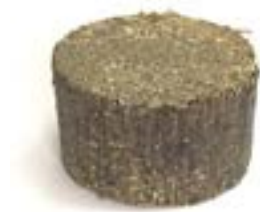
Рисунок 1. Биоугольный брикет из ливствы и угля Экибастузского месторождения
