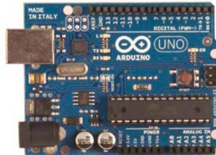
Рисунок 1 – Arduino UNO – пример Arduino-совместимой архитектуры
