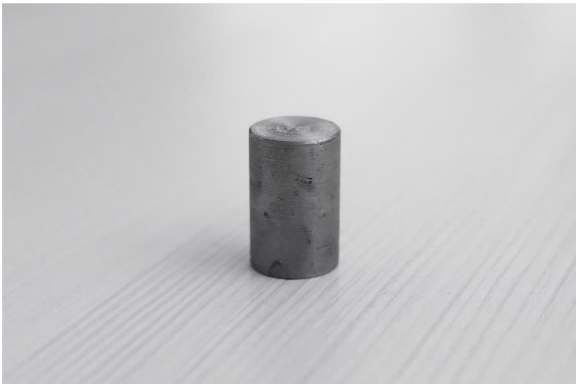
Рисунок 3 – Образец для испытания стали на сжатие
