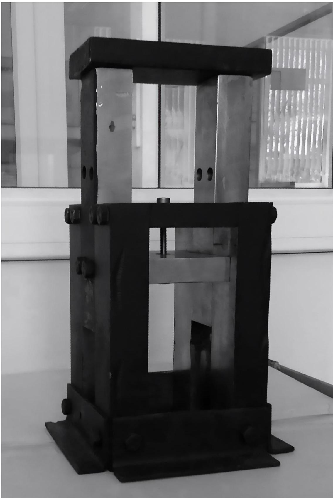
Рисунок 2 – Образец, установленный в реверсор
