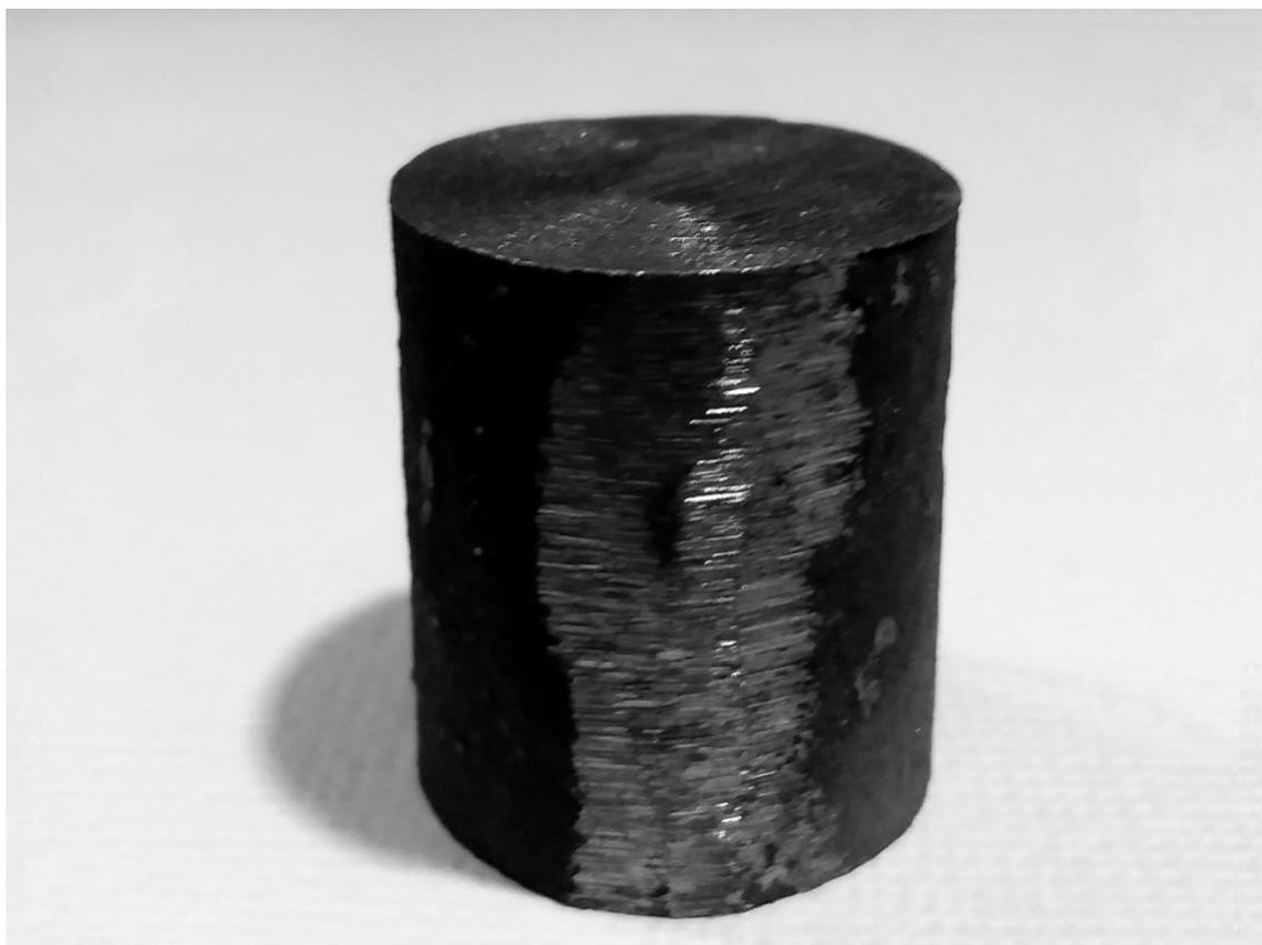
Рисунок 4 – Образец для испытания чугуна на сжатие
