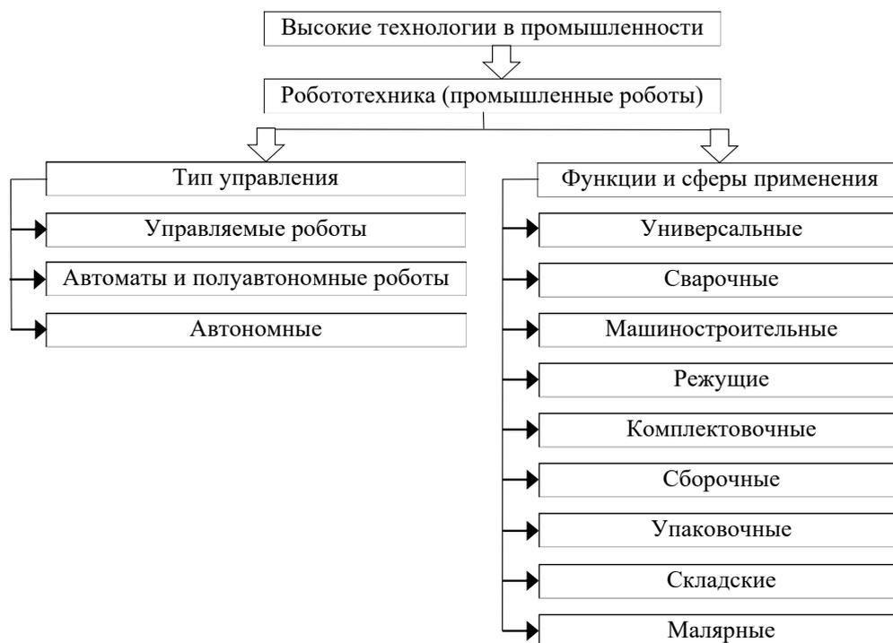
Рисунок 3 – Классификационные направления робототехники в промышленности
