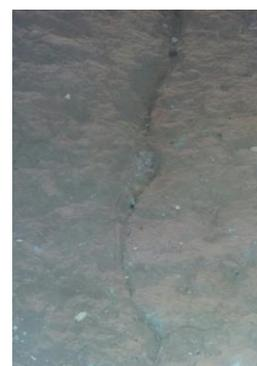
Рисунок 4 – Трещины в футеровке сталеразливочного ковша
