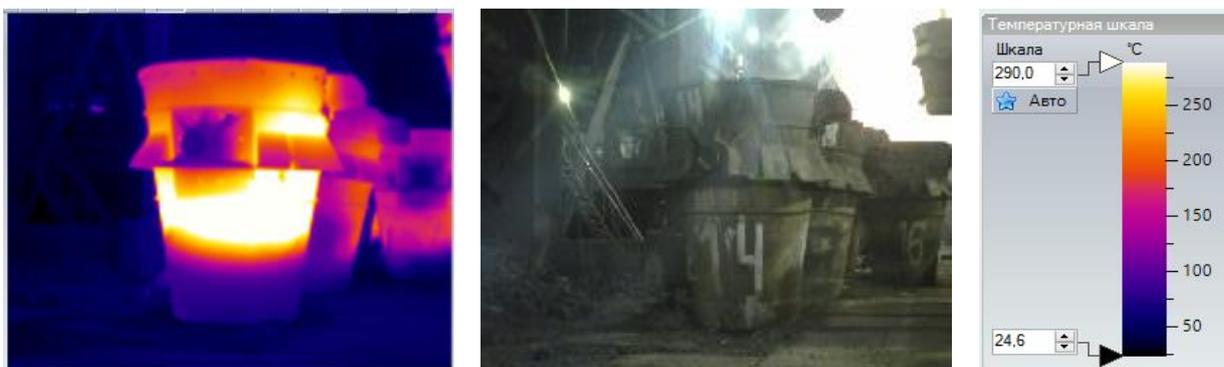
Рисунок 3 – Общий вид температурных полей поверхности разливочного ковша
