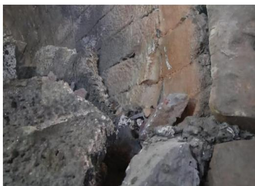
Рисунок 7 – Настыль на внутренней поверхности футеровки
