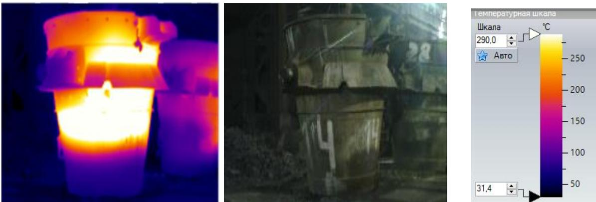
Рисунок 4 – Температурное поле поверхности ковша с зоной высоких температур падения струи при сливе расплава в ковш
