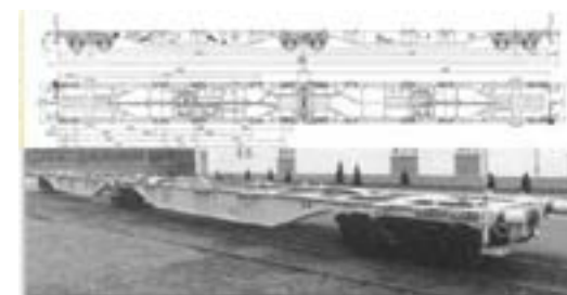
Рисунок 3 – Сочлененная вагон-платформа модели 6262
