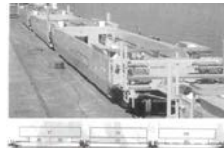
Рисунок 5 – Вагон-платформа типа Maxi Strack IV
