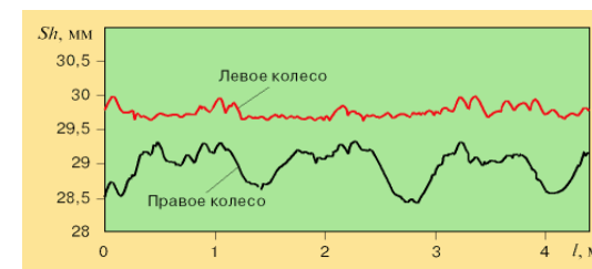
Рисунок 2 – Изменение высоты гребня по кругу на примере колеса поезда ICE
