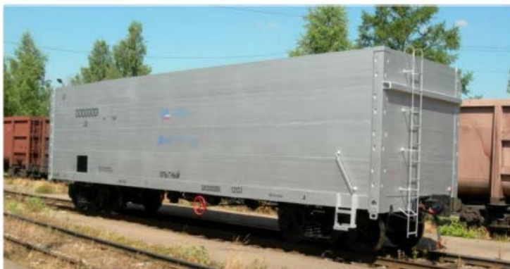
Рисунок 2 – Опытный полувагон, изготовленный с применением в конструкции кузова полых прессованных панелей (ВА 2005)
