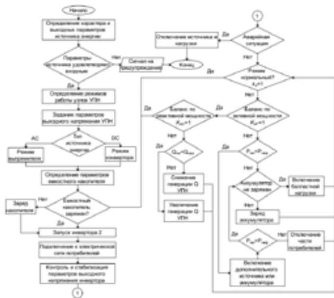
Рисунок 4 – Блок-схема алгоритма работы УПН, учитывающего требования обеспечения нормального режима работы автономной СЭС с ВДЭС
