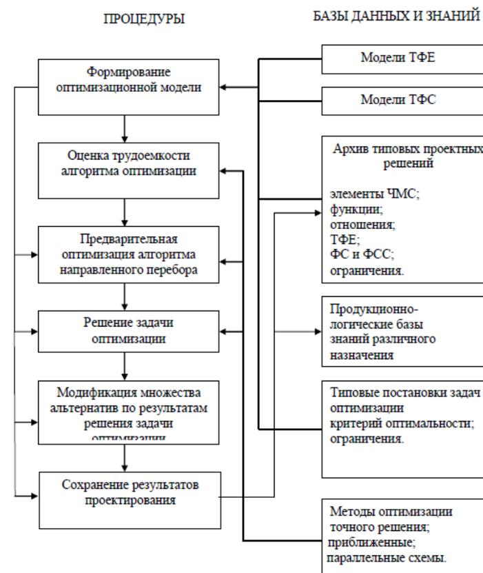
Рисунок 1 – Связь основных процедур и баз данных технологии проектирования
