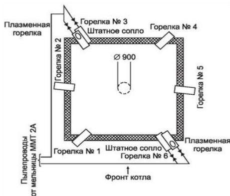
Рисунок 2 – Конфигурация горелок котлоагрегата
