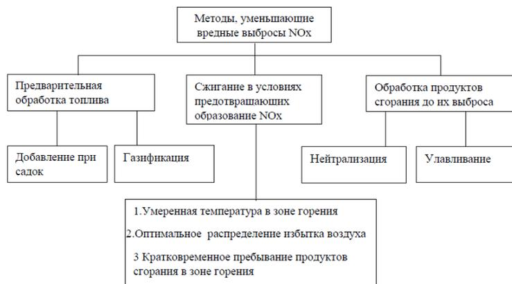
Рисунок 1 – Способы снижения выхода  $\text{NO}_x$
