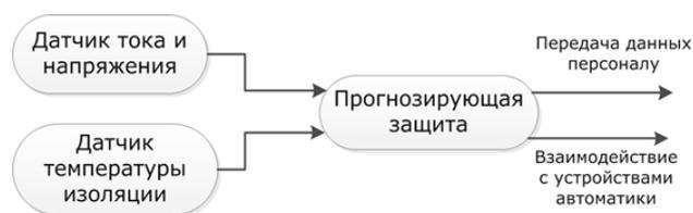
Рисунок 5 – Структурная схема прогнозирующей защиты
