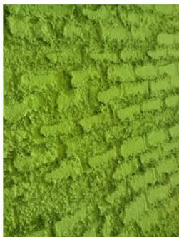
Рисунок 1 – Износ футеровки в виде чешуйчатого скалывания
