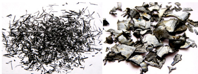
1 сурет – Шоғырландырылған сәулелену ағынының әсерінен балқыманың ультрафитті түрде сөнуі арқылы алынған бастапқы прекурсорлардың үлгілері
